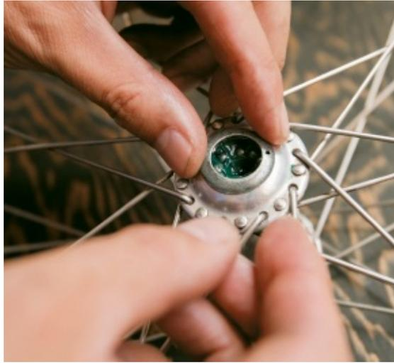
**Replace the dust cap if necessary.**
